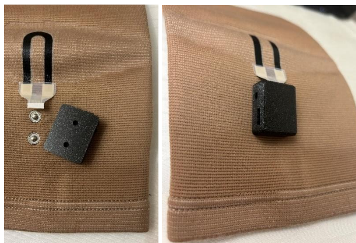
Rys. 91. Sposób montażu obudowy do opaski stabilizującej.
