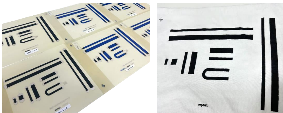
Rys. 36. Nadruki węglowych past WNL_CB i WNL_W na podłoże transferowe (lewo) oraz nadruk bezpośredni na dzianinę (prawo).
