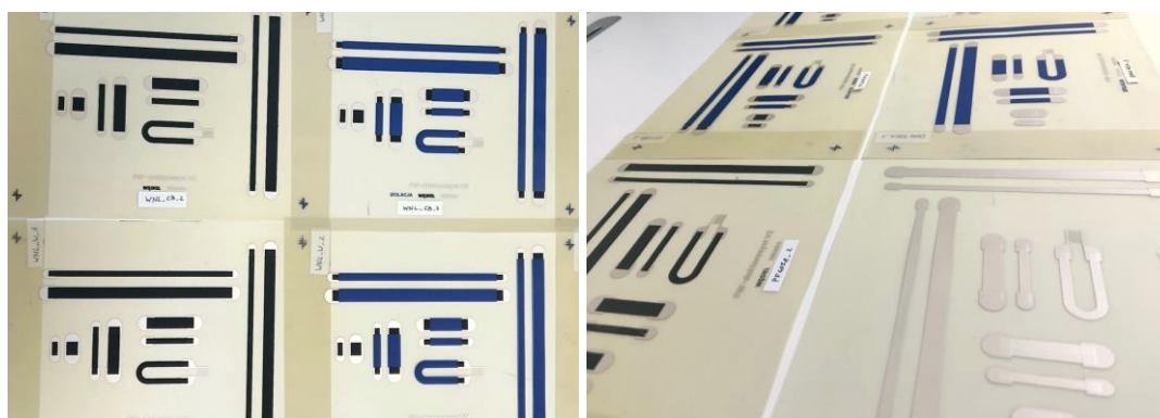
Rys. 31. Przykładowe nadruki charakteryzowanych past, wykonane na substracie PET-TT. Ścieżki koloru czarnego stanowiła pasta PF 407A, srebrne - EDAG 725A. Zastosowana na części próbek farba plastizolowa wyróżnia się kolorem granatowym.
