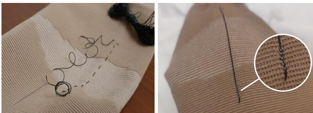
Rys. 20. Wszywanie włókna ścięciem prostym (lewo); mocowanie włókna na krańcach przy użyciu nici ze stali nierdzewnej (prawo).
