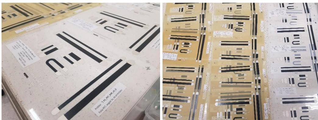
Rys. 70. Nadruki warstw piezorezystywnych po procesie suszenia.
