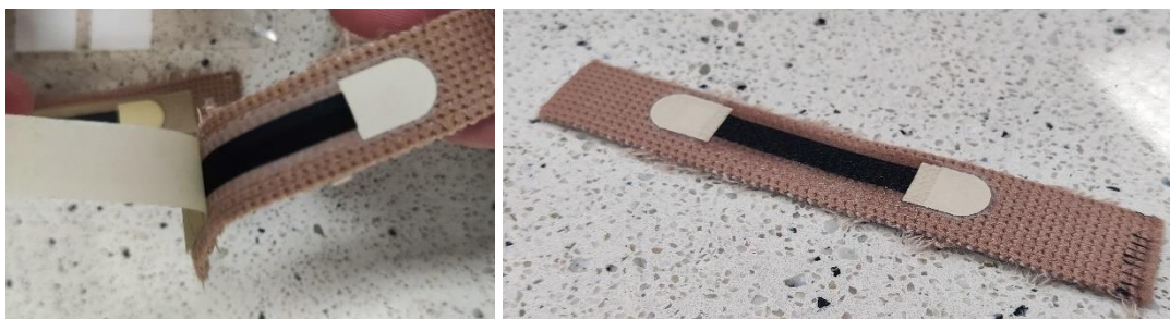
Rys. 67. Transfer ścieżki piezorezystywnej z folii transferowej na materiał dzianiny.
