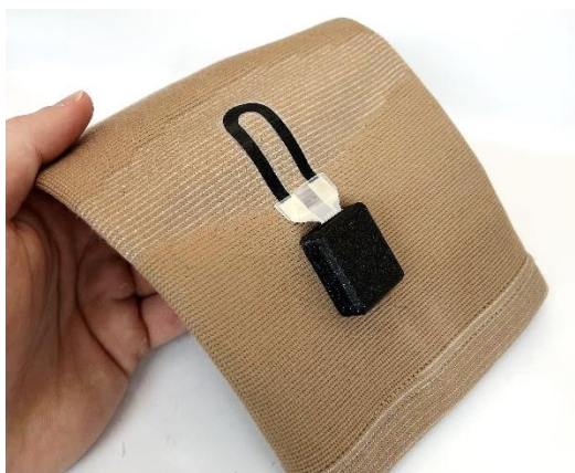
Rys. 85. Układ sensoryczny zintegrowany z opaską stabilizującą.
