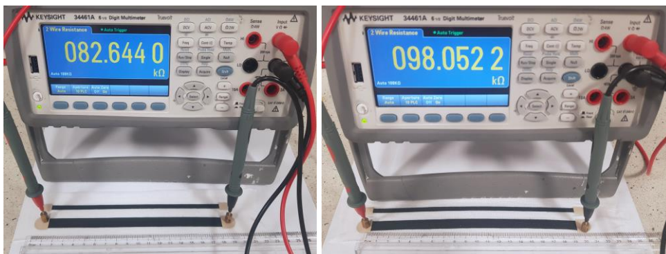
Rys. 48. Pomiar rezystancji ścieżki kompozytowej o osnowie TPU przy rozciągnięciu o 10% (lewo) i o 30% (prawo).
