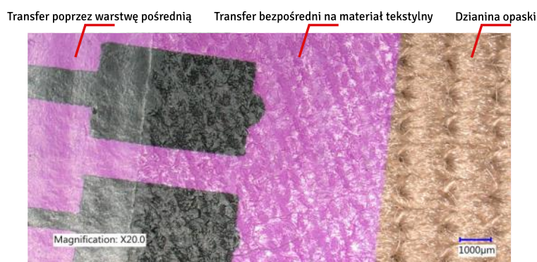
Rys. 46. Porównanie powierzchni nadruku transferowanej pośrednio i bezpośrednio na materiał tekstylny.
