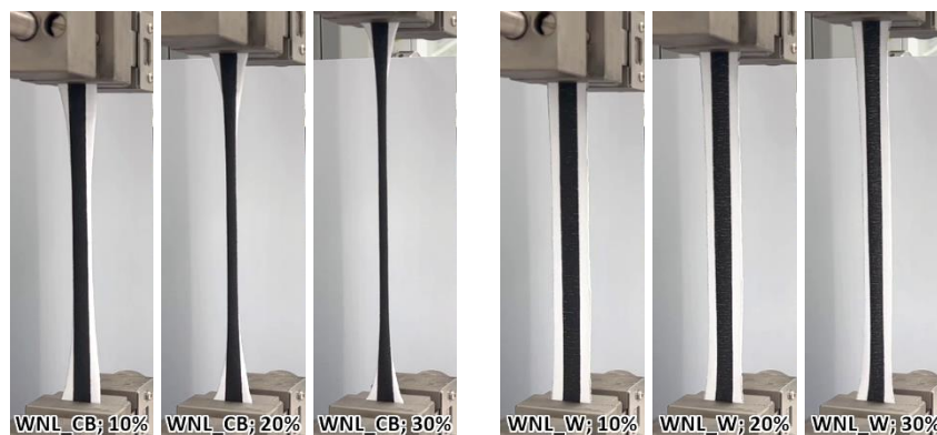
Rys. 38. Widok próbek kompozytów WNL_CB i WNL_W przy rozciągnięciu 10, 20 i 30%.
