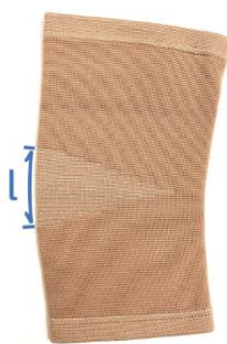
Rys. 4. Przykładowa opaska stabilizująca z zaznaczonym zakresem poddawanych pomiarom rozciągnięcia.
