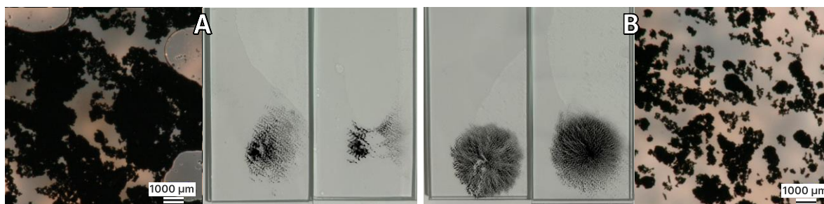
Rys. 54. Zdjęcie i obrazowanie mikroskopowe 5 µl kropli umieszczonej pomiędzy szkiełkami mikroskopowymi dla zawiesiny 1% m/m CB w DMF bez surfaktantu (A) oraz 1% m/m CB w DMF z cząstkami węglowymi modyfikowanymi SDS zgodnie z opracowaną procedurą (B).
