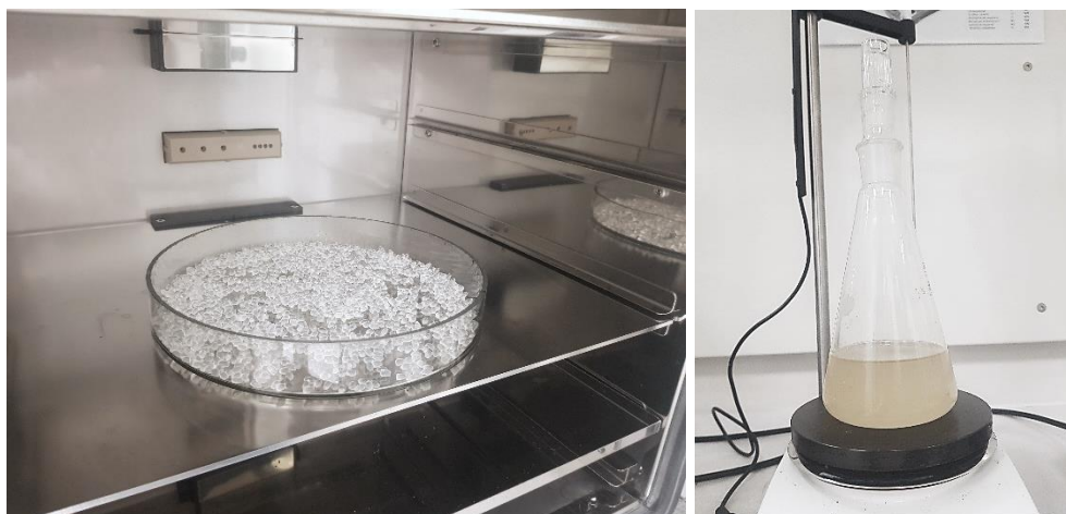
Rys. 56. Granulatu TPU po procesie suszenia (lewo) i nośnik w trakcie procesu mieszania (prawo).
