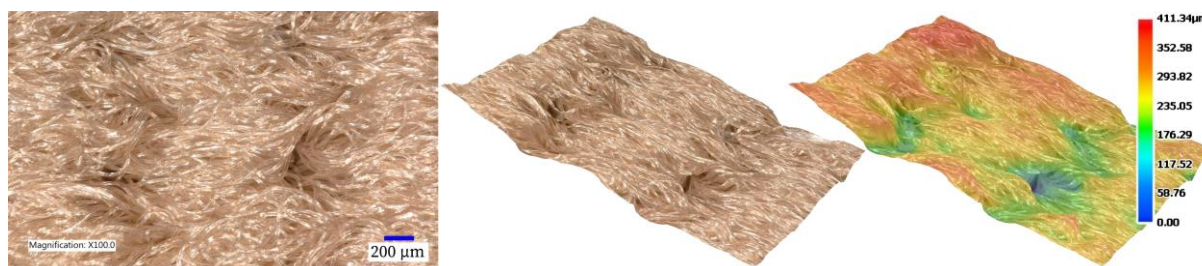
Rys. 45. Obrazowanie mikroskopowe dzianiny poliestrowej stanowiącej materiał opaski stabilizującej.
