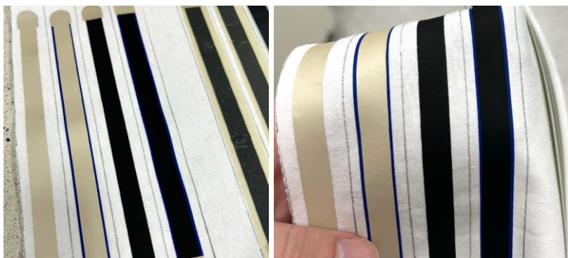
Rys. 33. Próbki ścieżek EDAG 725A i PF 407A po termotransferze na podłoże bawełniane.
